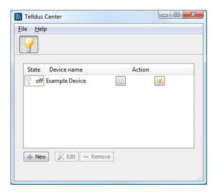
Zum Einschalten das gewünschte Gerät im Fenster auswählen und das Symbol mit der gelben Glühlampe anklicken. Das Gerät wird durch Anklicken des Symbols mit der grauen Glühlampe ausgeschaltet.
