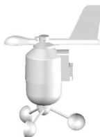
1 x 风力传感器 (1 x 置于上部的 风向标以及 1 x 置于 下部的风速计)
